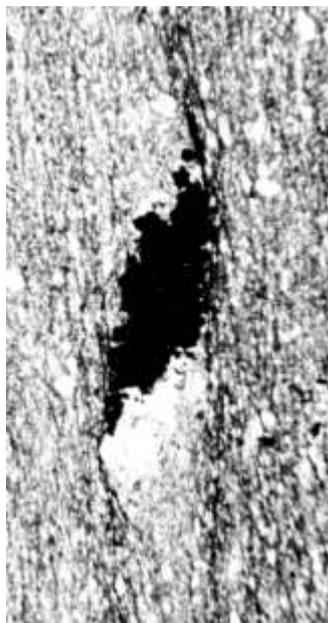
Рис. 11.38. Симметричная и асимметричная тени деформации в тыльных частях жестких зерен пирита
