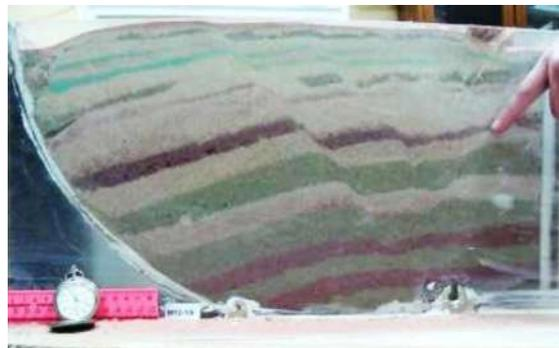
Рис. 6.33. Опыты с песком в Лаборатории тектонофизики и геотектоники МГУ.
