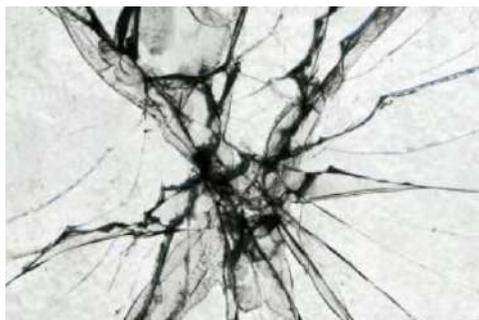
Рис. 6.31. Хрупкое разрушение
