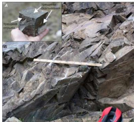
Рис. 6.10. Трещины отрыва и скалывания в массиве пород. (Бурзунова Ю.П. Геодинамика и тектонофизика, 2017)
