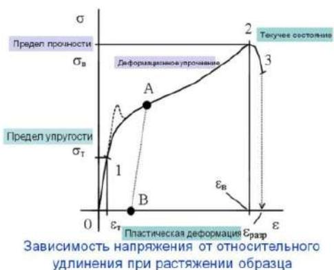
Рис. 6.28. Диаграммы для металла в условиях растяжения (имеет место структурная перестройка деформируемого материала)
