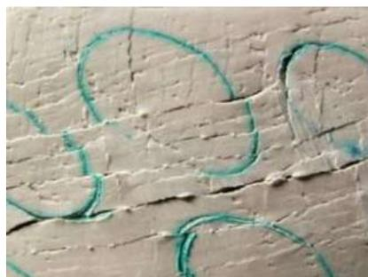
Рис. 6.32. Вязкое разрушение
