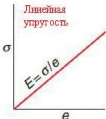
Рис. 7.21. График линейной упругости
