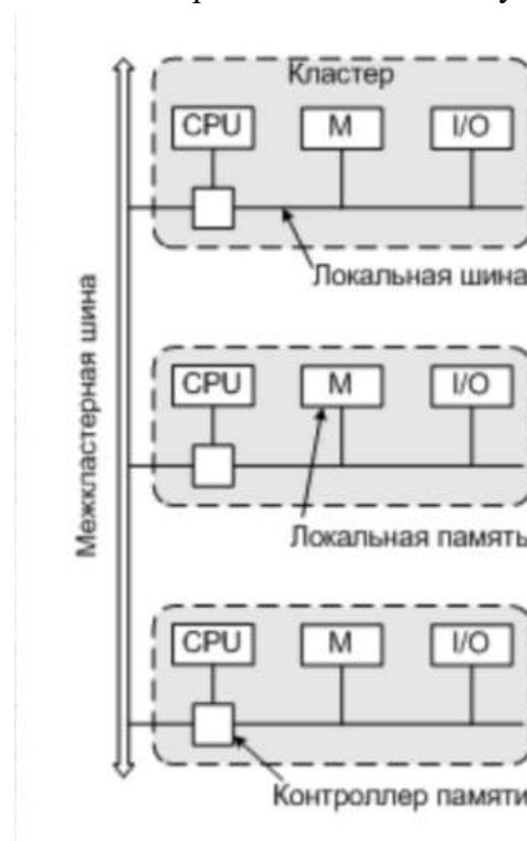
Рис.6.1. Архитектура NUMA, компьютер Ст* .
