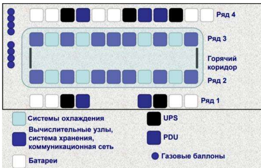
Рис.5.3. Компоновка системы SKIF МГУ «Чебышев».
