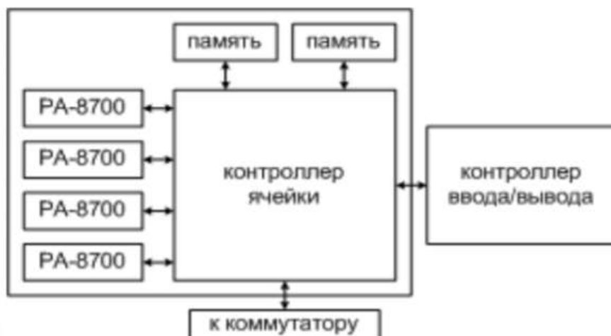
Рис.6.3. Структура компьютера Hewlett-Packard Superdome.
