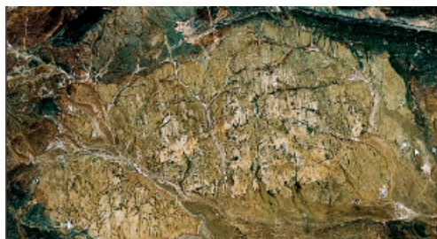
Рис. 15.21. Система вертикальных меридиональных Q трещин в массиве
