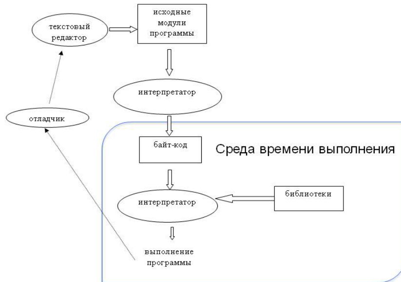
Рис.10.5 Общая схема функционирования основных компонентов СП на базе интерпретатора
