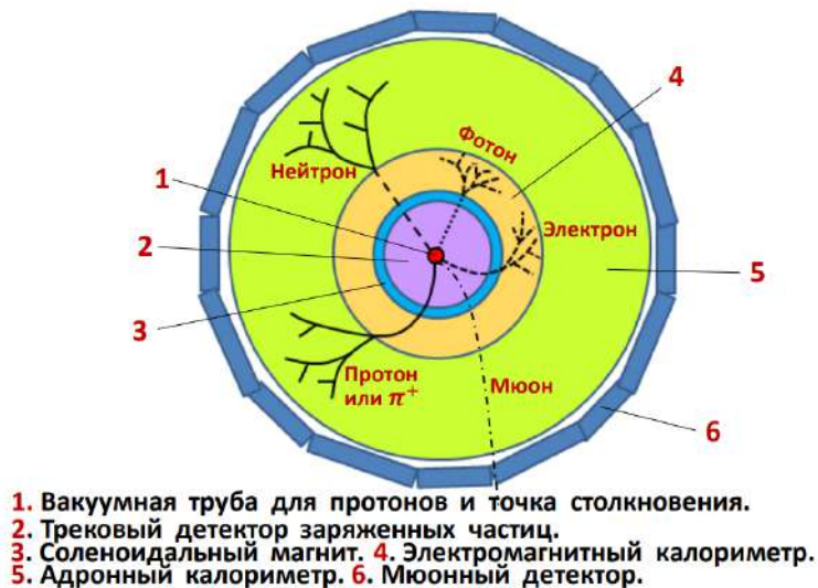
Рис.5.9. Поперечное сечение детектора ATLAS (вид вдоль оси сталкивающихся пучков протонов)
