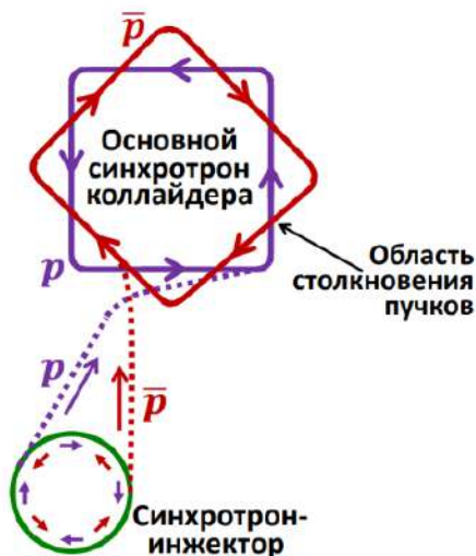
Рис.5.4. Коллайдер на базе синхротрона
