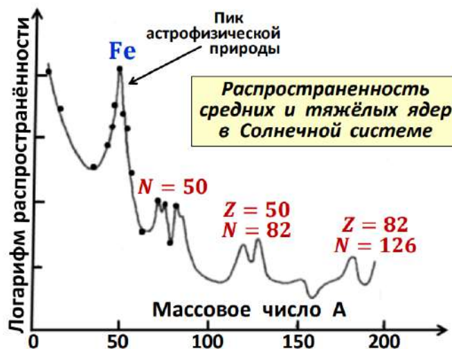
Рис.12.1. Экспериментальные данные, подтверждающие наличие магических ядер
