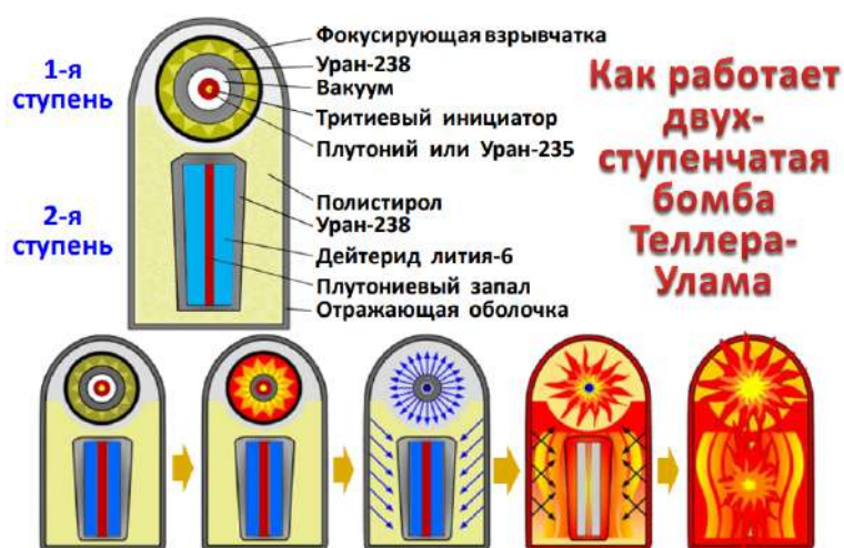
Рис.11.13. Двухступенчатая бомба Теллера-Улама
