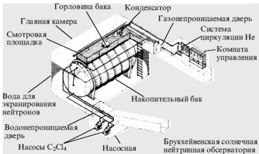
Рис. 27. Схема хлор-аргонного эксперимента
