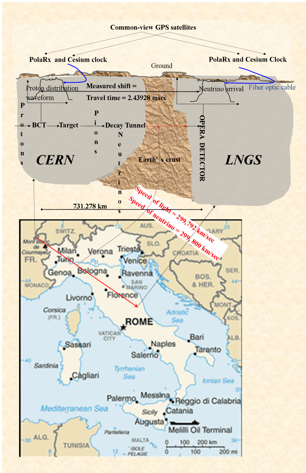
Рис. 54. Схема эксперимента, система синхронизации и карта, на которой показаны расположение ЦЕРН, Гран-Сассо и траектория нейтрино.
