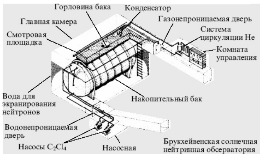
Рис. 27. Схема хлор-аргонного эксперимента
