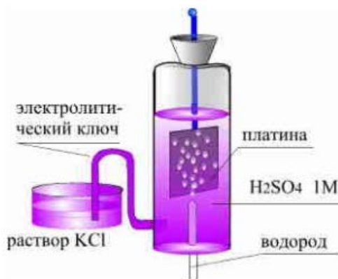
Рис. 4.3. Стандартный водородный электрод
