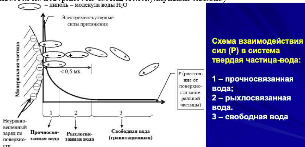
Рис. 6.29. Схема расположения молекул в пределах диффузионного слоя твердой частицы.
