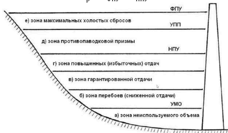
Рис. 17.8. Схема деления объема водохранилища на характерные зоны диспетчерского графика.
