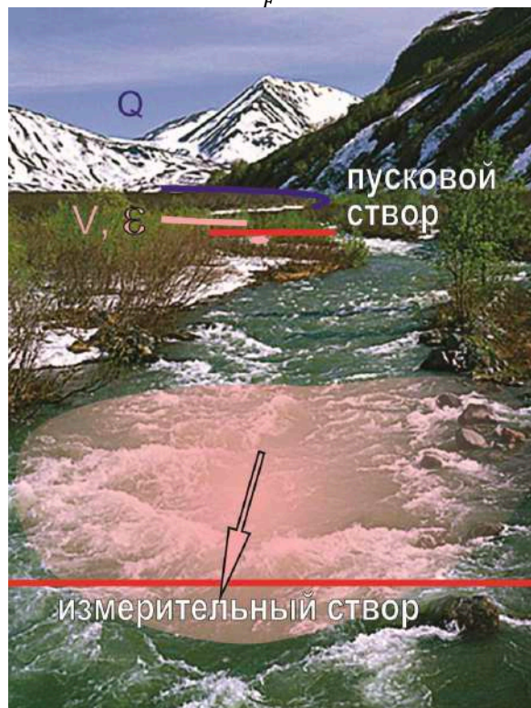
Рис. 11.17. Определение расхода воды с помощью ионного паводка.
