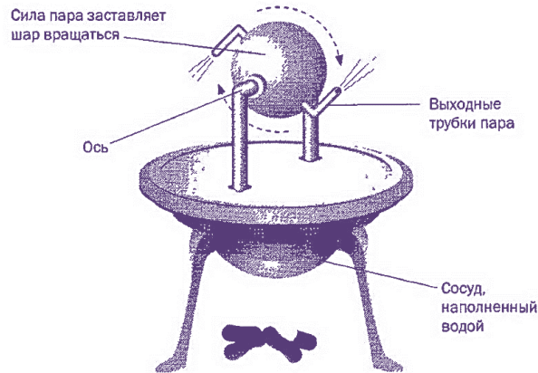
Рис. 1.1. Принцип работы Эолопила Герона
