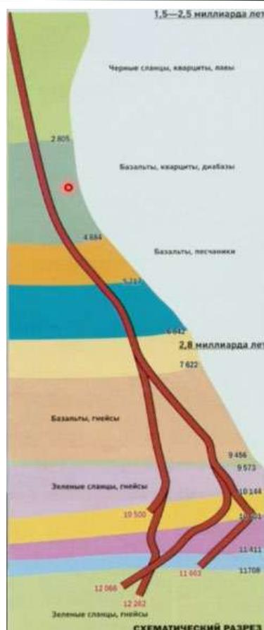
Рис. 3.10. Схематический разрез Кольской сверхглубокой скважины
