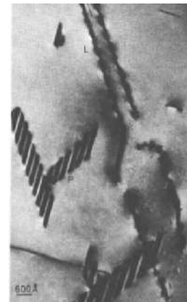
Рис. 15.20. Реальные дислокации в кристалле алмаза
