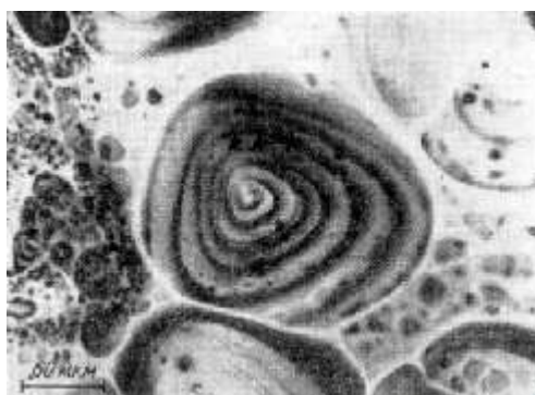
Рис. 17.3. Микрополости в арсениде галлия
