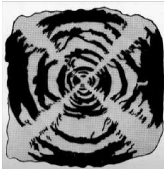
Рис. 6.5. Зональная структура гигантского (около 7 см) кристалла галита, обусловленная распределением серповидных участков галита и галопелитового материала (черное) по зонам роста кристалла, Белый крест - диагональные плоскости куба (ребра «пирамид роста»). Светлое галит.
