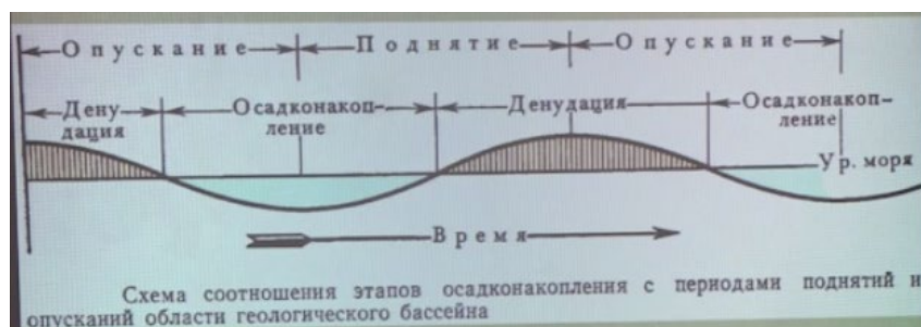
Рис. 5.2. Схема соотношения этапов осадконакопления с периодами поднятий и опусканий области геологического бассейна
