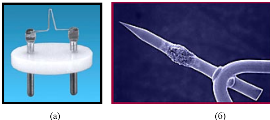
Рис. 6.5. Источники электронов: (а) термоионные; (б) полевые.
