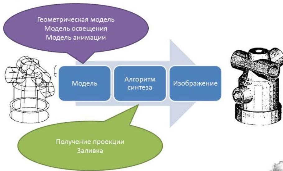
Рисунок 3.1. Графический процесс.
