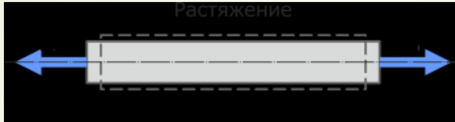
Растянем **упругий брусок**. Он удлинится в продольном направлении и укоротится в поперечном. Соотношение между продольными и поперечными деформациями было установлено Пуассоном (эмпирически)
