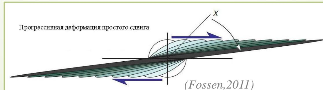
Простой сдвиг. Оси деформации поворачиваются.
