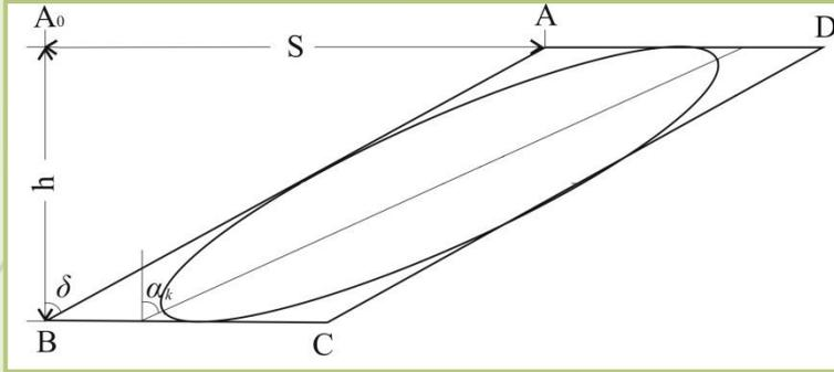
При фиксированной деформации сдвига ( $\delta$ ) единичный радиус круга испытывает максимальное удлинение при некотором угле наклона длинной оси эллипса деформации ( $\alpha_k$ ).
