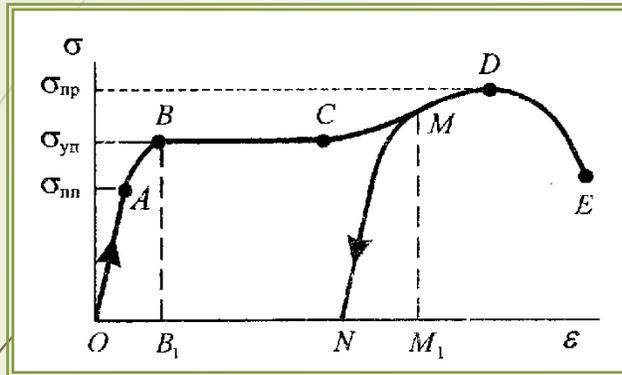
Диаграмма для металла в условиях растяжения (имеет место структурная перестройка деформируемого материала)
