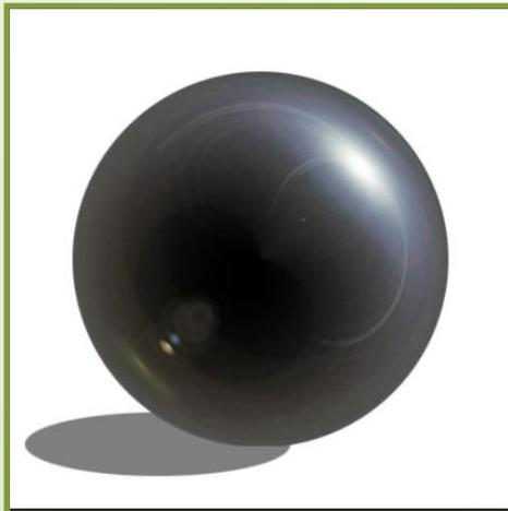
Напряженное состояние, когда главные оси напряжений равны ( $\sigma_1 = \sigma_2 = \sigma_3$ ), а касательные напряжения отсутствуют, определяется сферой; напряжение в любом направлении будет главным. Это случай равномерного всестороннего сжатия или растяжения
