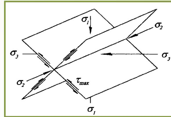
Плоскости максимальных касательных напряжений  $\tau_{max}$
