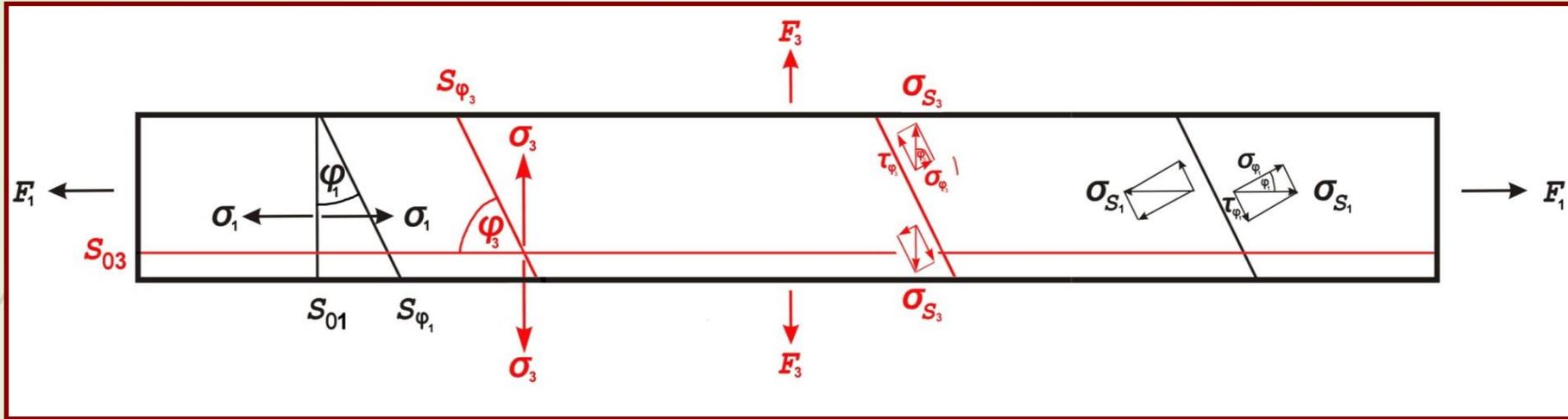
Вертикальное поперечное сечение бруса ( $S_1$ ), как и прежде, окажется под воздействием нормального напряжения  $\sigma_1 = F_1 / S_1$ .
