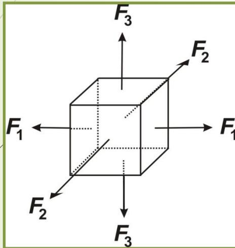
И в этом случае плоскость максимальных касательных напряжений ориентирована под углом  $45^\circ$  к осям максимального и минимального нормальных напряжений, а само максимальное касательное напряжение таково:
