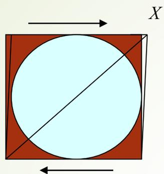
Ось эллипса **малых приращений** деформации простого сдвига ( $X$ ) ориентирована под углом  $45^\circ$  к направлению сдвига (а это, как будет показано ниже, есть ориентировка оси напряжений).
