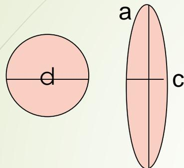
**Коэффициент удлинения**  $k_1$  определяется как отношение длинного радиуса эллипса деформации к длине диаметра первоначального круга:  $k = a/d$  (1). Коэффициент укорочения  $k_3$  определяется как отношение короткого радиуса эллипса деформации к длине диаметра первоначального круга  $k_3 = c/d$ . При отсутствии нижнего индекса будем под  $k$  подразумевать коэффициент удлинения.
