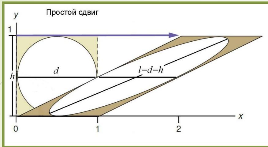
*По определению, все точки тела, испытывающего деформацию простого сдвига, движутся параллельно одной прямой, или направлению сдвига, и проходят путь, прямо пропорциональный расстоянию от этой прямой.*
