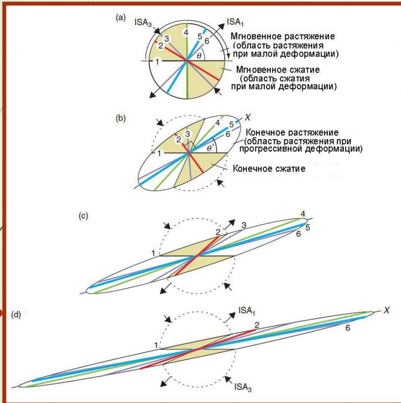
В отличие от чистого сдвига, в котором длинная и короткая оси эллипса деформации все время представляют собой одни и те же материальные волокна и лишь меняют свою длину, при простом сдвиге это разные волокна. Иными словами, контур эллипса, представляющий собой геометрическое место материальных точек первоначального круга, в процессе деформации уподобляется гусенице трактора.
