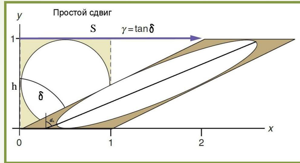
1. *Угол сдвига  $\delta$*  (мера деформации прямого угла). Угол отсчитывается от перпендикуляра к направлению сдвига. Другими словами, это разница между первоначальным прямым углом и острым углом параллелограмма, после деформации.
