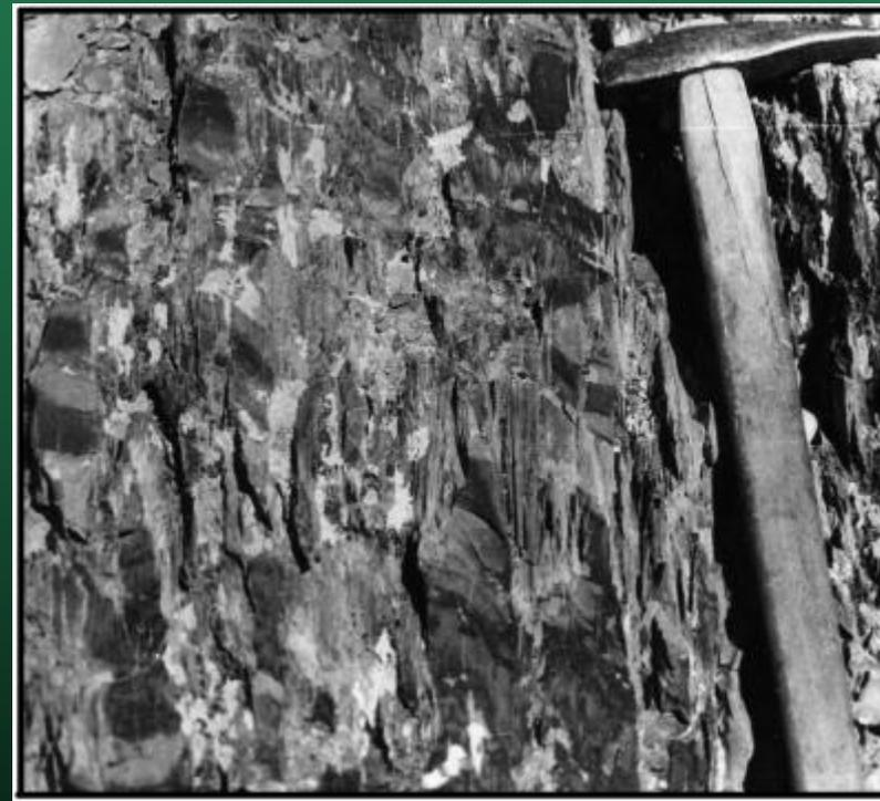
В швах концентрируется деформация укорочения
