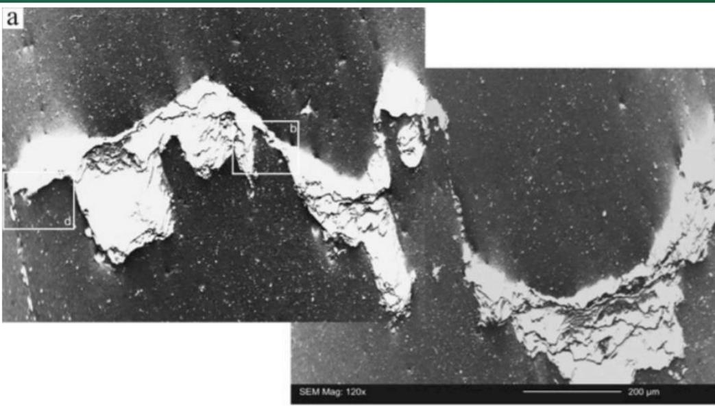
Сканирующая электронная микроскопия. Зрелые тектонические стилолиты в мелкозернистых юрских известняках. Значительное изменение толщины остаточного слоя глины (*no Ebner et al., 2010*)
