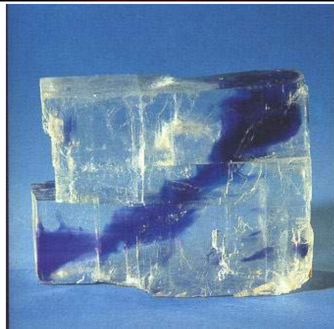
Рис. 2.2. Дефекты нестехиометрии в кристалле АВ. Стехиометрия нарушена в сторону избытка А. Квазисвободные электроны локализованы на анионных вакансиях
