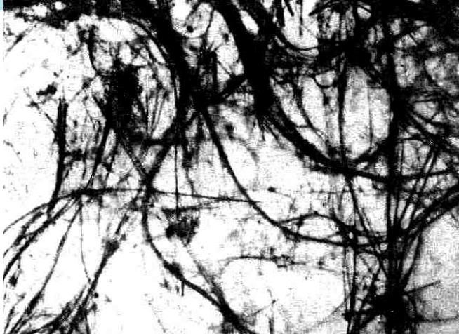
Хризотил-асбест. Толщина нитей ~ 0.2 микрона
