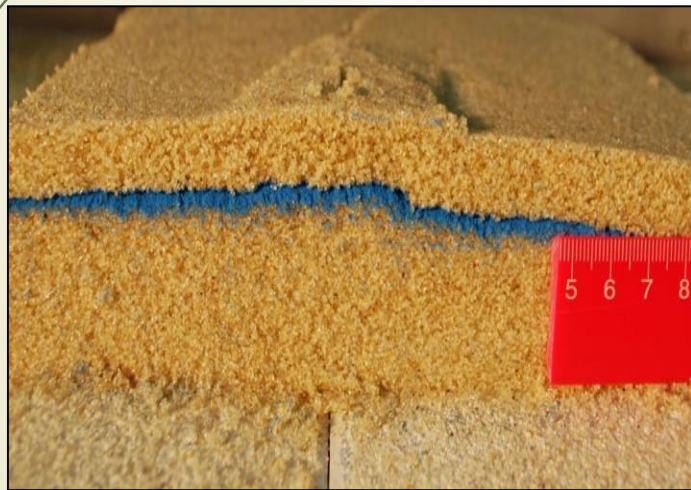
Разрезы. Хорошо видна цветковая структура и асимметрия вала
