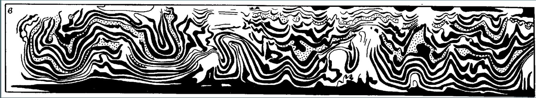
Во всех экспериментах из-за малой разности температур в подошве и кровле образцов и специфике режима прогрева (в термокамере) процесс конвекции был близок к стационарному. В природе подъем геоизотер происходит достаточно медленно, поэтому процесс конвекции должен быть нестационарным
