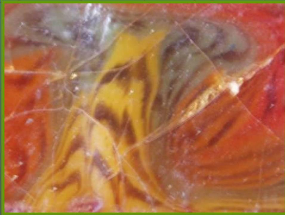
Фрагмент модели из канифоли. В центре - область поднятия, осложненная складками, и две области опускания по краям
