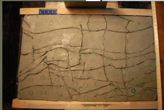
Моделирование деформаций фундамента Скифской плиты (по В.А. Зайцеву)
