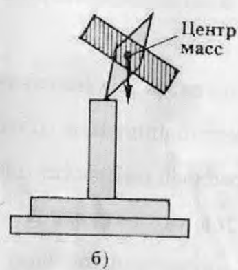
Рис. Модели вращающихся тел, имеющих одну неподвижную точку, предложенные Н. Е. Жуковским: а — случай Л. Эйлера; б — случай Ж. Лагранжа; в — случай С. В. Ковалевской (ЦМ — центр масс).
