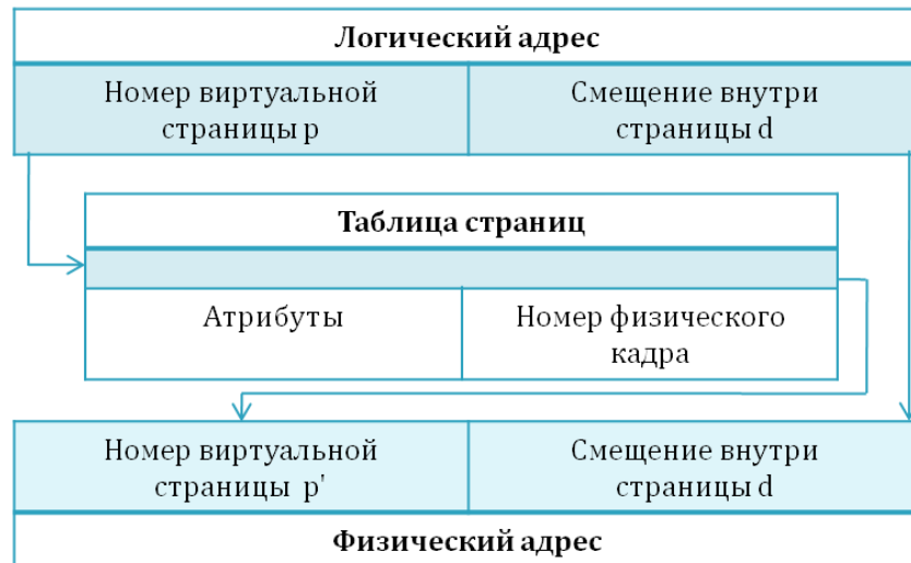
Рис. 9.1. Связь логического и физического адресов при страничной организации памяти
