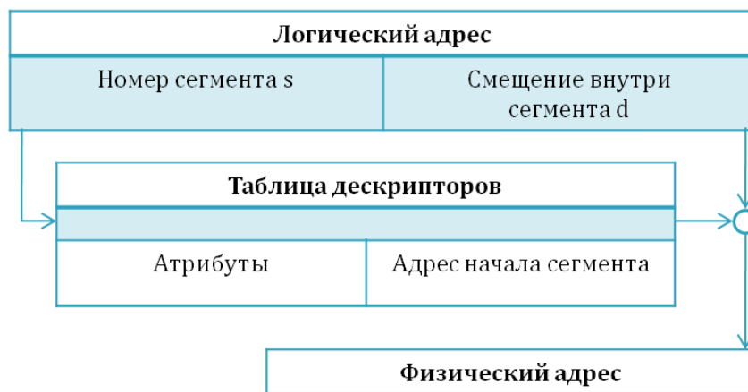
Рис. 9.2. Преобразование логического адреса при сегментной организации памяти
