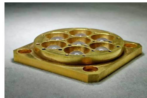
Практическая топология интегрального устройства в составе излучающей матрицы из 7 пикселей
